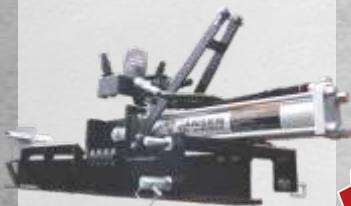
Hydrauliköl-Versorgung über die Anschlüsse des Fahrzeuges
