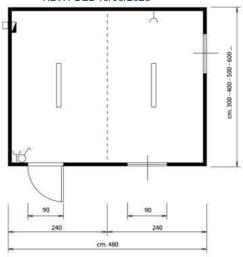
STANDARD INNER HEIGHT 223 CM - EXTERNAL 245 CM STANDARD INNER HEIGHT 240 CM - EXTERNAL 270 CM STANDARD INNER HEIGHT 270 CM - EXTERNAL 298 CM
