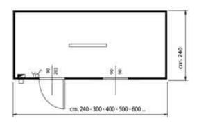
STANDARD INNER HEIGHT 223 CM - EXTERNAL 245 CM STANDARD INNER HEIGHT 240 CM - EXTERNAL 270 CM STANDARD INNER HEIGHT 270 CM - EXTERNAL 298 CM
